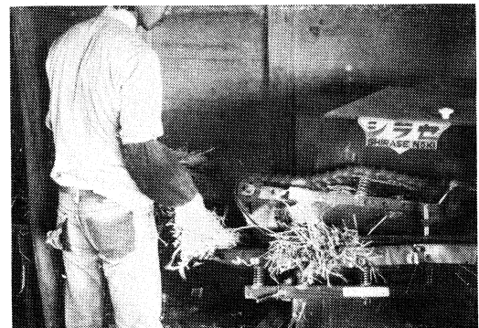
動力用チェーン送脱穀機 (これまでに手廻, 動力用手まわし等各種あり)
