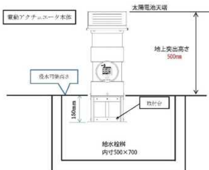
図70. 給水栓柵の寸法及びWATARAS設置概要
