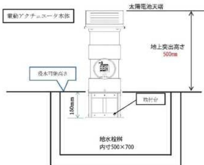
図 70. 給水栓枡の寸法及び WATARAS 設置概要
