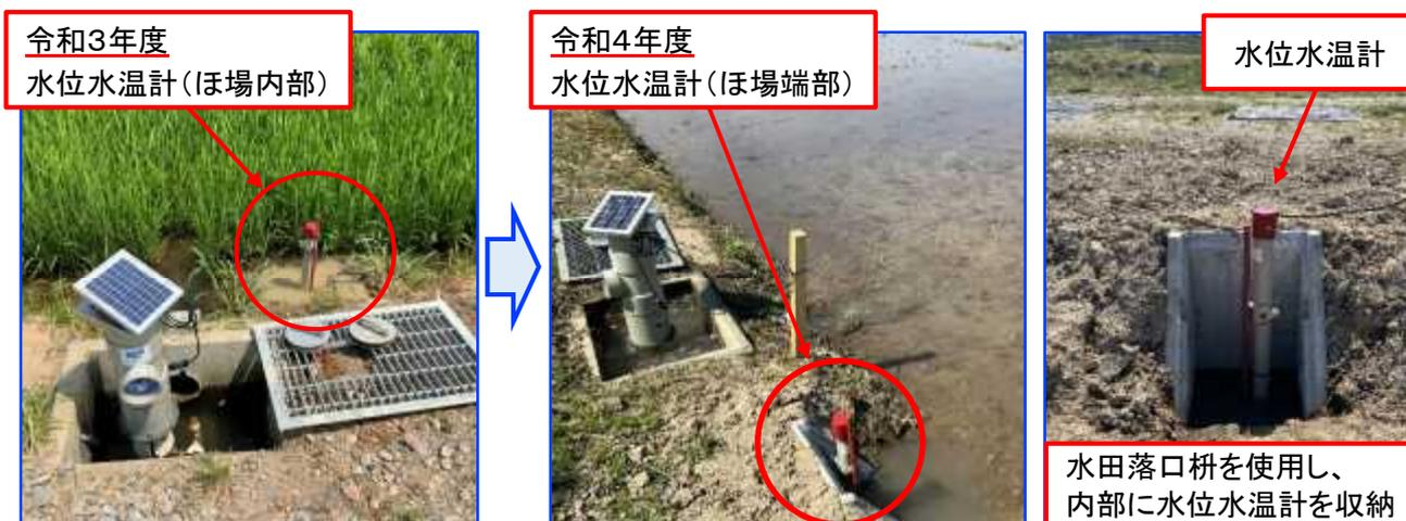
図 16. 水位水温計の設置状況（令和3年度・令和4年度比較）
